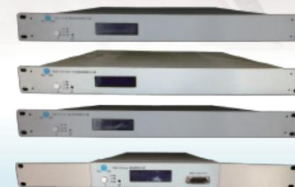
LXI故障注入器
