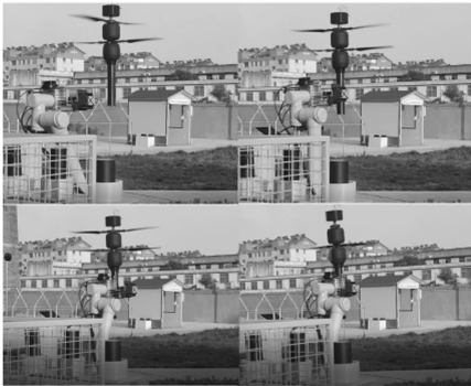
图 15 共轴双旋翼无人机抓取实验
