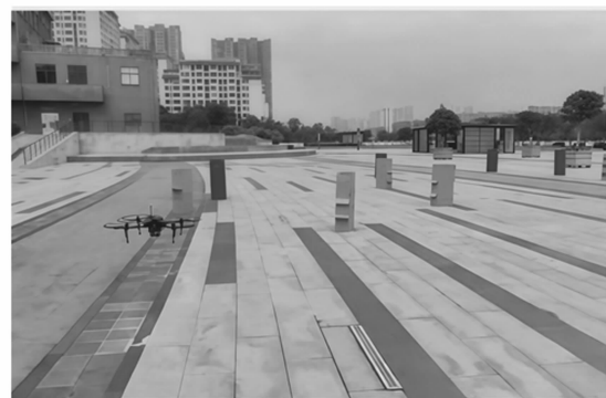
图9 无人机避障试验示意图
