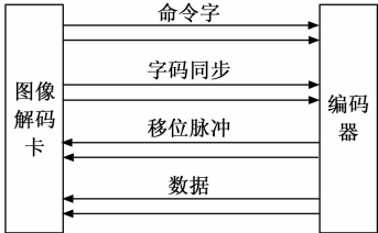
图 4 数字量接口信号组成和流向关系图
