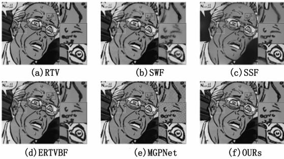
图 9 不同算法的平滑结果比较
