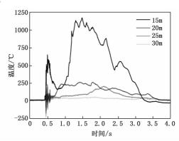
图 10 不同距离处热电偶爆炸温度实测曲线
