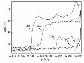
图 11 爆炸火球的热辐射信号
