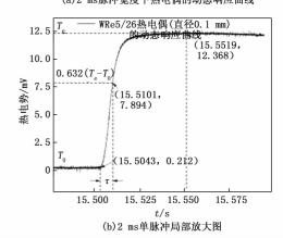
图 5 WRe5/26 热电偶动态响应曲线图
