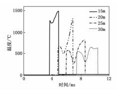
图 7 不同距离爆炸热响应温度一时间曲线
