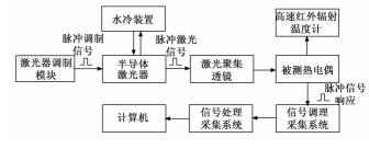
图 4 动态测试系统框图
