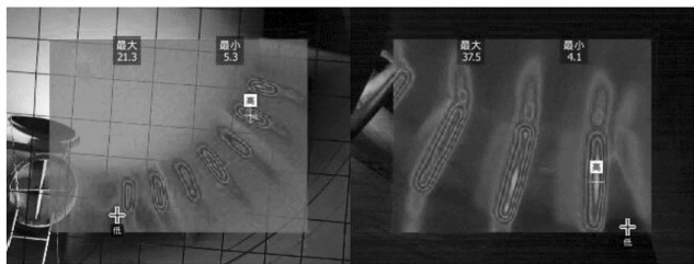
图 13 风扇叶片电加热温度测试
