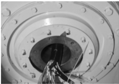
图 6 转子系统空心轴端结构
