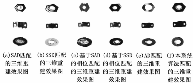
图 12 不同匹配算法下三维重建结果示意图
