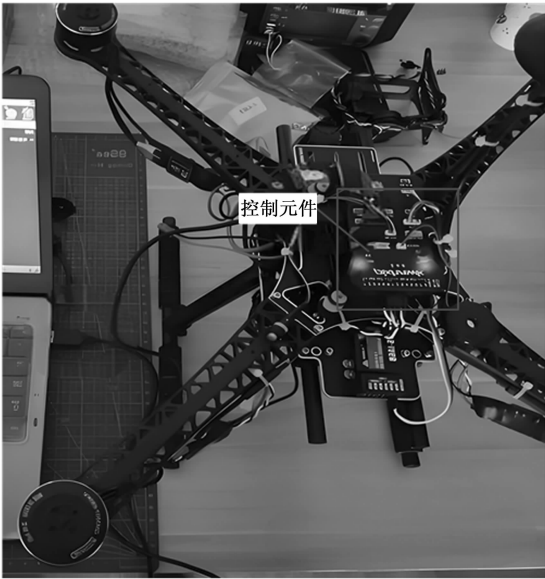
图 4 姿态鲁棒控制元件的安装实景
