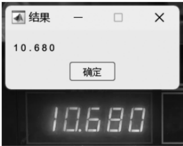
图 10 电子秤示值数字识别结果
