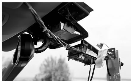
图 6 毫米波雷达设备安装实景
