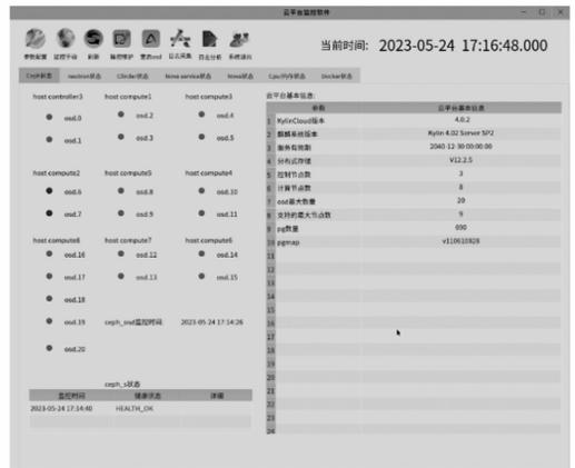
图 3 Ceph 及 osd 监测结果图
