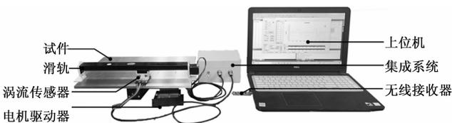
图 15 集成化涡流检测系统
