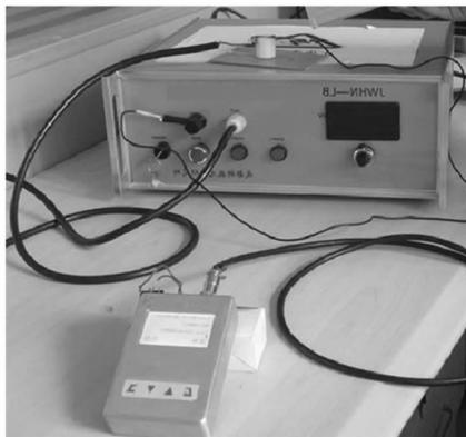
图 8 非线性分布式故障检测系统硬件设备连接实景
