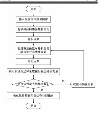
图 3 利用卷积神经网络提取热斑图像特征流程图
