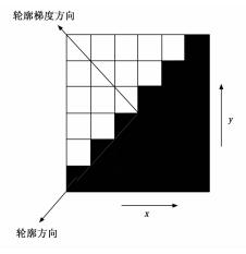
图 4 光伏组件热斑图像轮廓特征示意图
