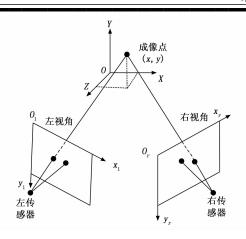
图 1 移动机器人目标多模态数据采集原理图
