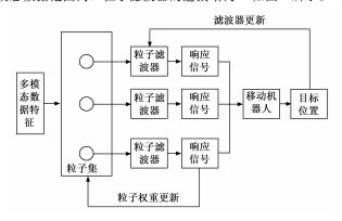
图 2 多模态数据范围内粒子滤波器连接结构图
