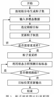
图 3 粒子滤波器运行流程图
