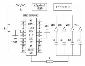
图 1 铁路轨道移频信号测量系统电源模块结构图
