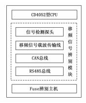
图 4 移频信号辨别模块结构示意图
