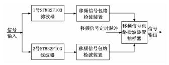
图 2 定时脉冲情况下的微处理器连接模型
