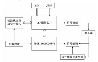
图 5 铁路轨道 DSP 测量单元运行模式
