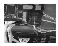
图 10 真空罐中的被测 FPGA 芯片
