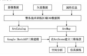
图 3 警务战术训练系统软件设计流程图
