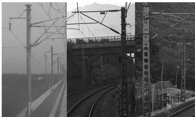
(a) 杆号牌位于支柱本体 (b) 杆号牌位于支柱横腕臂 (c) 杆号牌位于支柱外侧
