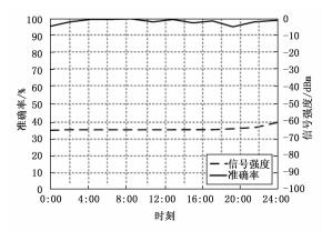
图 6 传输准确率及信号强度随时间变化曲线图
