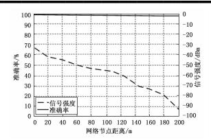
图 7 传输正确率及信号强度随距离变化曲线图
