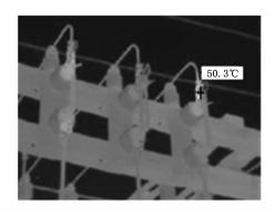
图 4 变电站温度较高的实际位置
