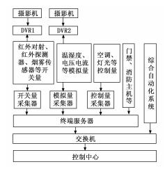
图 1 安防监测数据采集系统结构
