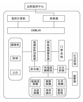
图 2 变电站一体化安防管控系统结构
