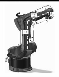
图 1 机器人圆柱体包围盒模型
