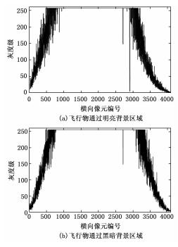
图 3 目标飞行物所在行的图像灰度分布图
