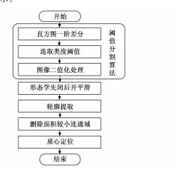
图 16 图像处理算法流程图
