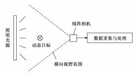
图 1 线阵相机动态目标拍摄系统结构
