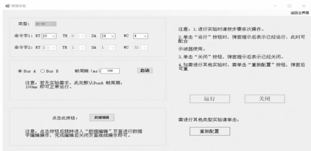
图 7 BC→RT 消息通信实例参数配置界面
