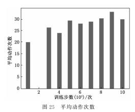
而失败,仅有的成功是由于初始化时仪表恰处于画面中心位置,因此该阶段数据不具有参考性。随后的训练中机器人表现逐渐稳定,从第3000轮至第7000轮训练机器人基本能以百分之百的成功率将相机镜头对准仪表,并且平均执行动作数在25步到30步之间。
