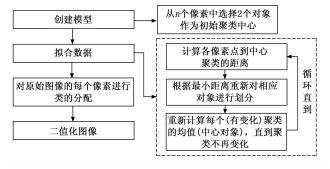
图 14 K-means 二值化算法流程图
