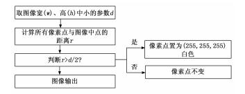
图 16 内切圆算法流程图
