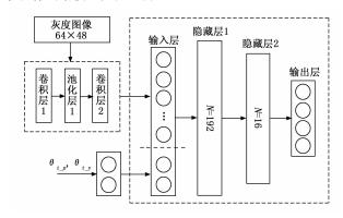
图 7 改进后 DQN 的深度网络部分模型
