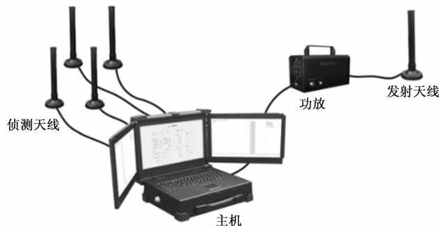
图2 射频通信干扰器布局图
