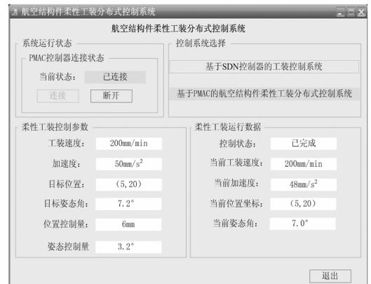
图 6 航空结构件柔性工装分布式控制系统运行界面
