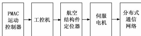
图 1 基于 PMAC 柔性工装硬件系统的整体组合框图
