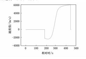
图 2 火箭飞行径向速度
