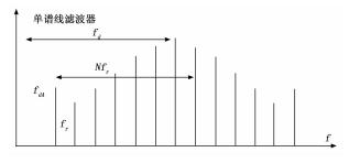
图 8 单脉冲雷达频谱图
