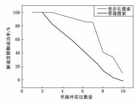
图 11 解速度模糊成功率与多站跟踪雷达数量关系
