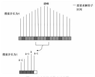
图 10 变步长搜索算法示意图
