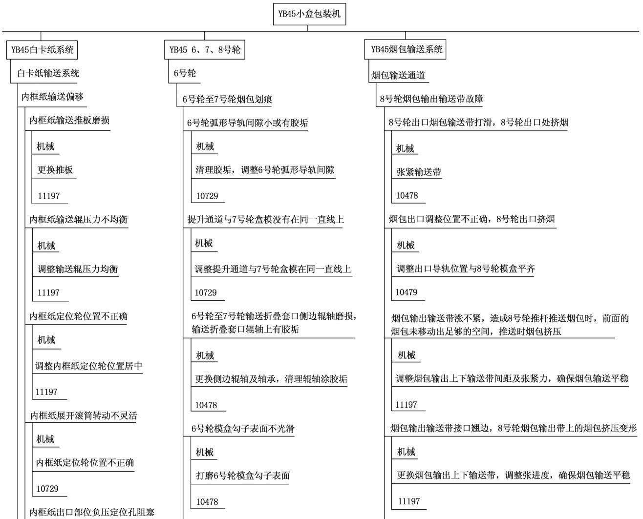
图 3 故障树与故障编码关联
