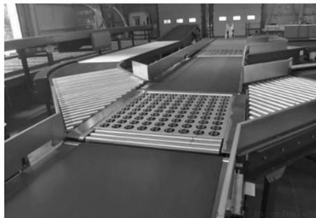
图 6 分流输送装置
