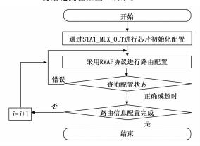
图 5 AT7910E 初始化流程
