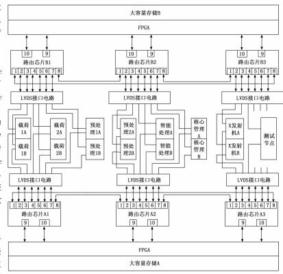
图 3 智能处理通用平台 SpaceWire 网络连接图
