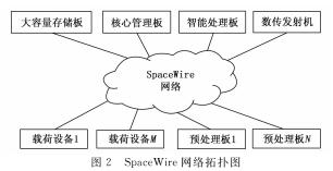
在实际应用中,光学载荷数据量极大(Gbps带宽), 此类载荷通常不直接接入SpaceWire 网络,经载荷数据预处 理后生成百兆级有效数据后,接入网络进行深度处理、融 合分析以及存储。
