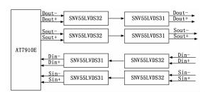
图 4 防静电 LVDS 接口电路
