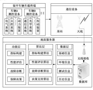
图 1 装甲车辆 PHM 系统构成示意图
