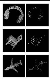
图 8 输入点云目标(左)与网络模型提取的关键点(右)对比图
