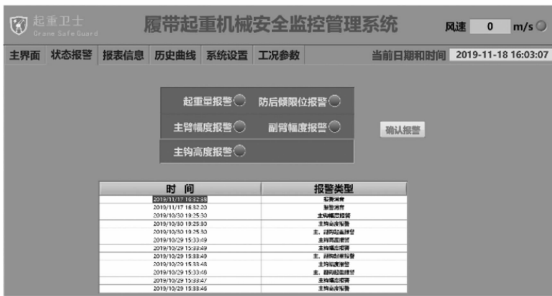
图 6 安全监控管理系统报警界面
