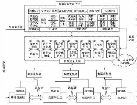
图 2 智慧校园安全管控平台总体框架
