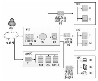
图 3 智慧校园安全平台部署后测试网络拓扑图
