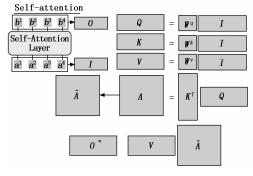
图 8 自注意力机制原理
