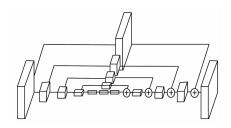
图 3 单个沙漏模块
