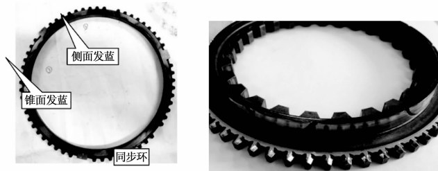
图6 故障锥体和同步环实物
