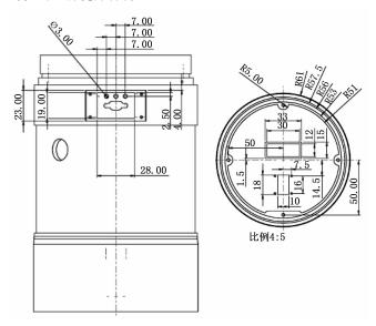
图 1 防毁记录仪的外层结构
