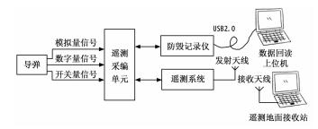
图 3 弹载遥测采编存储系统组成及框图
