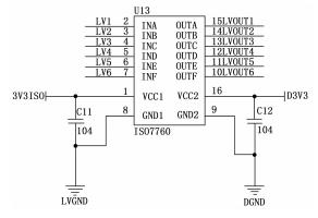
图 7 LVDS 隔离电路图
