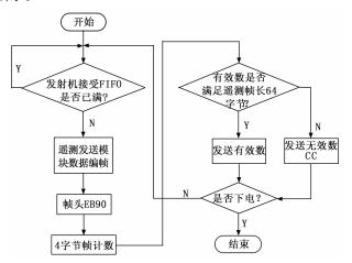
图 10 遥测发送模块逻辑框图
