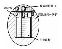
图 2 防毁记录仪的内层结构
