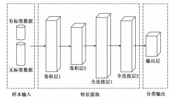
图 4 CNN 结构图
