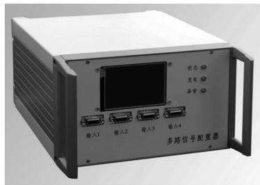
图 4 多通道信号切换设备实物照片
