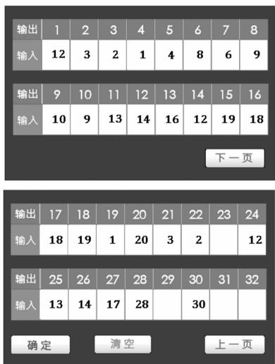
图 6 多路信号切换设备触摸屏显示界面
