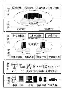
图 1 边缘计算入侵防御系统模型
