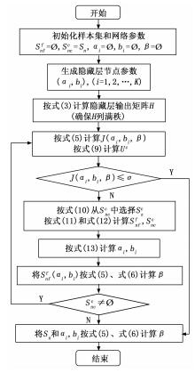
图 3 TSS-ELM 算法流程图
