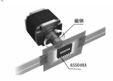
图 2 原理结构图
