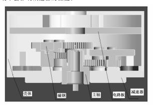
图 6 编码器三维结构图
