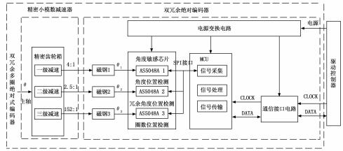
图 1 双冗余多圈绝对式编码器系统框图
