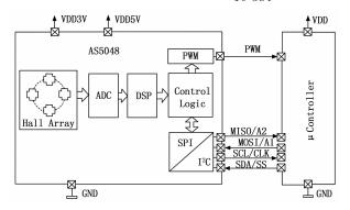
图 3 AS5048A 芯片内部结构图
