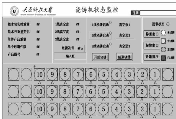
图 7 浇铸机状态监控界面
