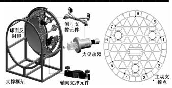
图 2 集成了力促动器的 SiC 球面反射镜及主动支撑点的分布
