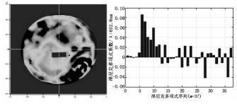
图 7 反射镜的初始基准面形
