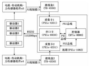
图 4 工控机测控模块框图
