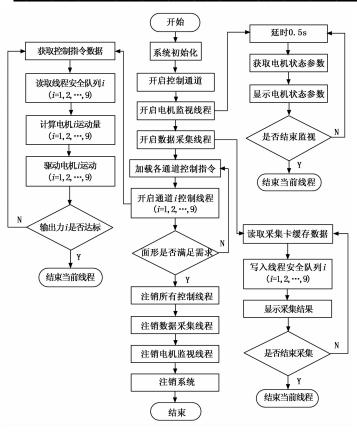
图 5 实验系统软件控制流程图
