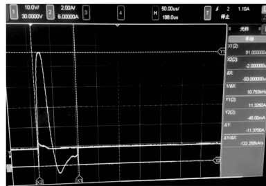
图3 电源切换时浪涌电流波形
