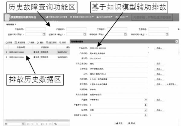
图 10 基于质量数据模型的辅助排故软件
