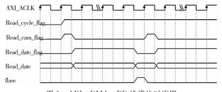
图 5 AXI\_DMA\_RD 读模块时序图
