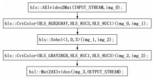
图 11 基于 HLS 实现 Sobel 算子的设计流程
