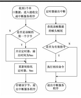
图 9 串口 1 或 3 数据接收中断处理流程
