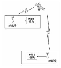
图 5 使用 9602 的点对点通信测控信道
