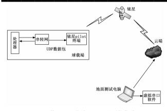
图 6 使用 pilot 终端基于 IP 的测控信道
