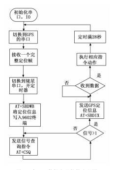
图 8 串口 2 数据发送软件流程图
