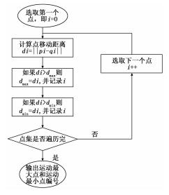
图 8 最优两点的搜寻流程图
