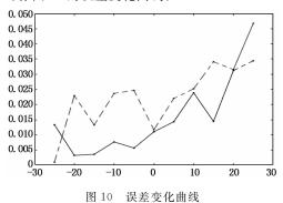
图 10 中,虚线为曲面样点计算(即轴线不垂直)的误差曲线,实线为平面样点计算轴线(即垂直)的误差曲线。从图 10 中可以看出,在轴线不垂直时的误差相对与轴线垂直的误差较大,随着角度增大误差也增大。前者的主要原因是轴线垂直重合过程两步即可完成,一步是平移,另一步是旋转;而轴线垂直不垂直时重合过程有三步,一步平移和两步旋转。随着角度增大误差也增大的主要原因是角度每一次增加会有一定的误差累积,该情况在很多算法中也会存在,是一个通病,可不作为衡量算法好坏的标准。通过本精度验证实验可知,本试验的三点重合算法的误差在 0.05 度范围内,该误差满足实际生产中飞机活动面的转角测量要求。
