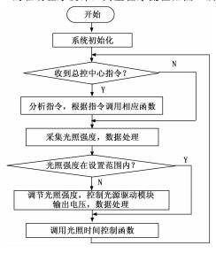
图 6 补光调控节点主程序流程图
