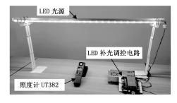
图 7 补光调控电路的实验测试图
