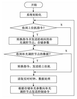
图 5 补光总控中心主程序流程图
